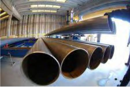
Il tubo in acciaio a saldatura orizzontale mediante tecnologia HFI-W ad alta frequenza ha i seguenti vantaggi
