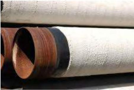
Il rivestimento antiroccia rappresenta una protezione meccanica, applicata sul rivestimento anticorrosivo del tubo (bitume, polietilene, etc.), realizzata in cemento rinforzato con tessuto in fibra di vetro opportunamente studiato per assolvere alla funzione di materiale composito.
