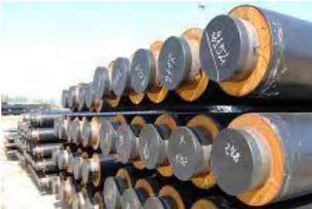
La continua ricerca di nuove tecnologie, volte alla soluzione del contenimento dei consumi energetici a livello mondiale, ha portato alla sperimentazione e realizzazione di sistemi di trasporto con tubi in acciaio rivestite con schiume poliuretatiche in grado di assicurare alti rendimenti nel trasporto di fluidi destinati al teleriscaldamento e/o
